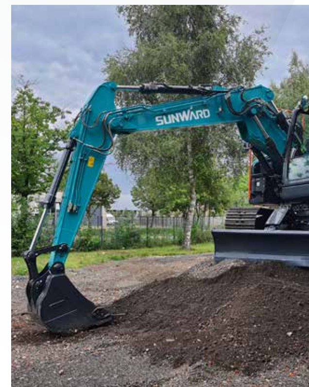
Les axes du balancier et du godet sont conçus pour une durée d'exploitation standard de 20 000 heures.
