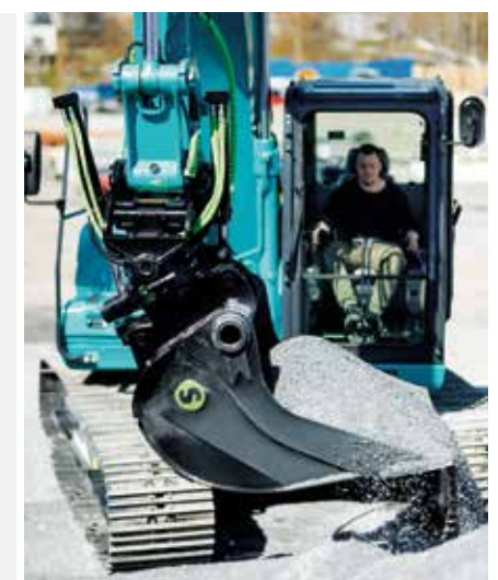
■ 3 serienmäßige Zusatzleitungen erleichtern die Arbeit mit Tilt-Rotatoren
