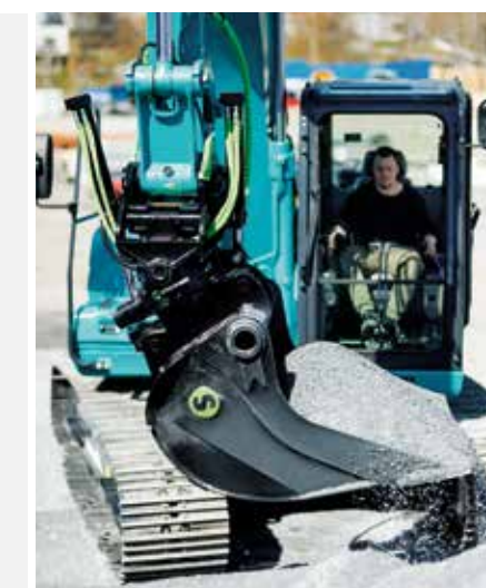
3 linee ausiliarie di serie rendono facile l'uso di rotatori inclinabili
