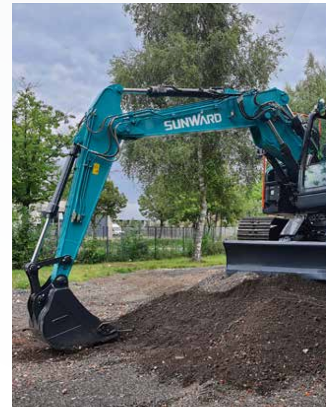
Les axes du balancier et du godet sont conçus pour une durée d'exploitation standard de 20 000 heures.
