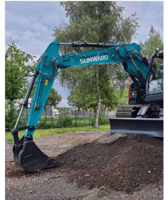
■ Schwingarm und Löffelstange sind auf eine Zuverlässigkeit von 20.000 Stunden ausgelegt.
