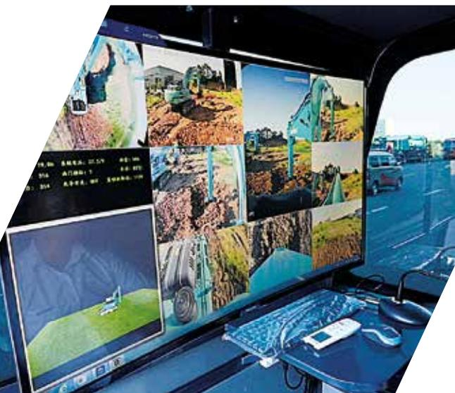
◀ Escavatore pesante azionato in remoto tramite cabina 5G
